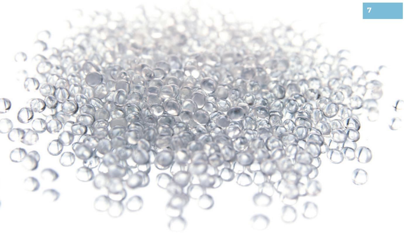
**Edistir® N 3840** è un polistirene che abbina ad un'alta fluidità buone caratteristiche meccaniche. Può essere impiegato in coestruzione per ottenere gli strati lucidi dei manufatti del vending. Se mescolato con polistirolo antiurto tradizionale, consente di realizzare manufatti termoformati ad alto angolo di sformatura (vasetti yogurt). Tramite stampaggio e grazie alla sua fluidità, consente di realizzare con cicli veloci, contenitori aventi parti sottili e complesse.
